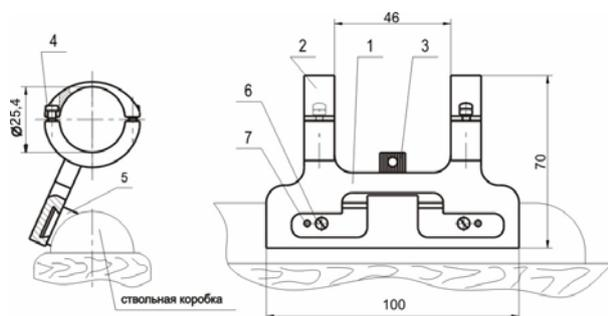
1. Кронштейн 2. Охват 3. Винт стяжной 4. Винт крепежный
