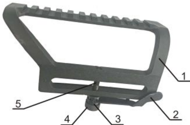
1 – база; 2 – флажок; 3 - бочонок; 4 – фиксатор; 5 – винт стяжной
