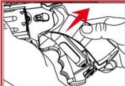
Для открытия отсека для баллончика CO2 потяните заднюю крышку назад.
