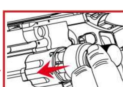
Вставьте ускоритель заряжания с фальшпатронами в барабан револьвера.
