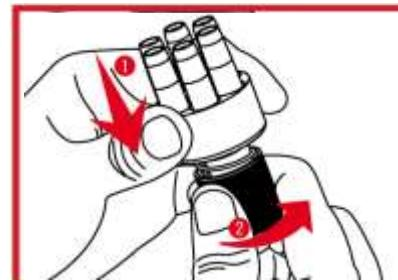
Зафиксируйте фальшпатроны, нажав на ускоритель заряжания и повернув вправо его рукоять.
