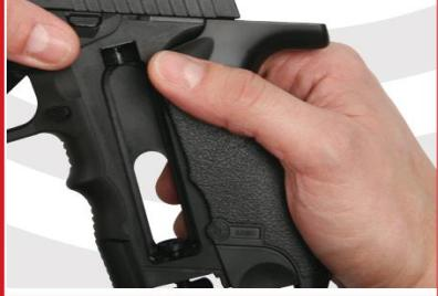
Для открытия отсека для баллончика СО<sub>2</sub> нажмите на верхнюю часть задней крышки рукояти и вытяните заднюю крышку назад.
