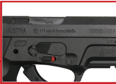
Для снятия пистолета с предохранителя, нажмите на предохранитель и отведите его влево. Если красная точка видна, пистолет готов к стрельбе.
