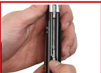
Поверните и удерживайте пружину, зафиксировав ее в этом положении.
