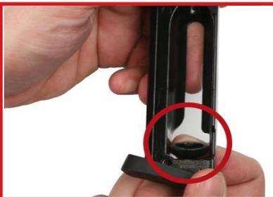
Отрегулируйте винт-заглушку, чтобы он плотно прилегал к баллончику CO2.
