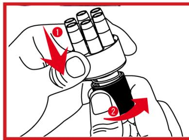
Зафиксируйте фальшпатроны, нажав на ускоритель заряжания и повернув вправо его рукоять.
