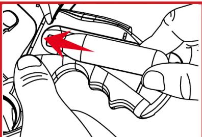
Для открытия отсека для баллончика CO2 потяните заднюю крышку назад.
