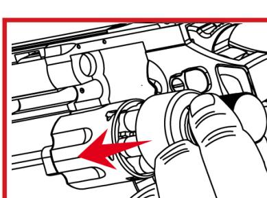
Вставьте ускоритель заряжания с фальшпатронами в барабан револьвера.
