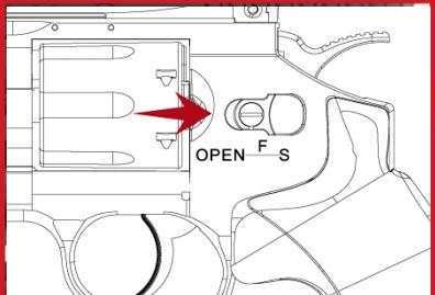
По умолчанию, предохранитель должен быть всегда во включенном состоянии. Нажмите на предохранитель вправо S для включения безопасного режима.
