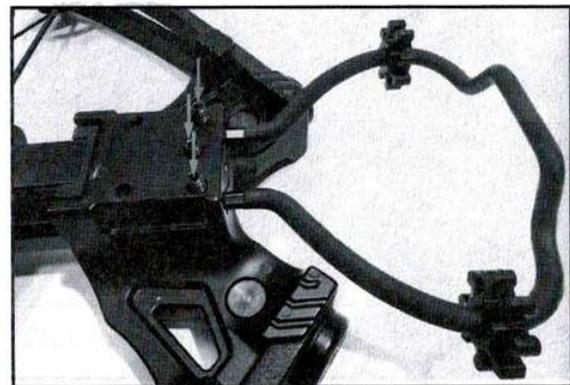
6. Вставьте стремя в отверстия. Затяните контр-винты (два для стремени и один для лимб-болта)
