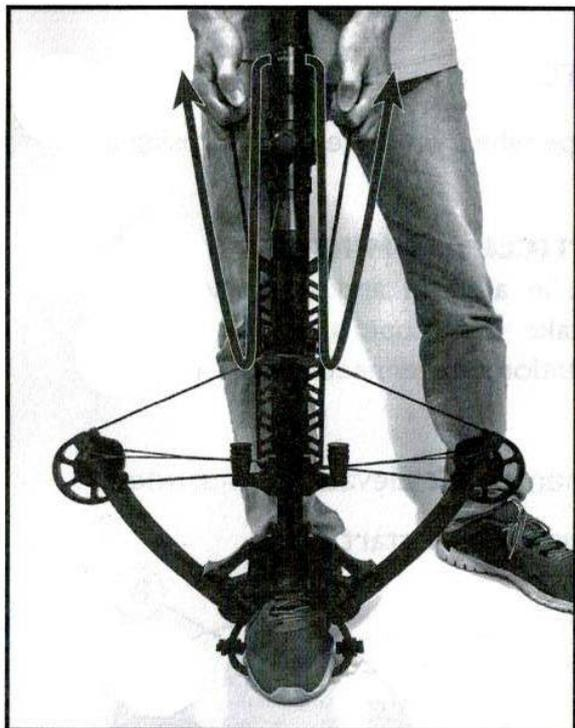
23. Вставьте ногу в стремя. Равномерно потяните за ручки натяжителя вверх пока круки не доведут тетиву в замок с 2 щелчками (первый - это срабатывание замка, второй - установка предохранителя в "safe". Ослабьте натяжитель, снимите круки с тетивы. Установите стрелу на направляющую маркированным пером вниз и сдвиньте назад до упора. Теперь ваш арбалет готов к выстрелу.
