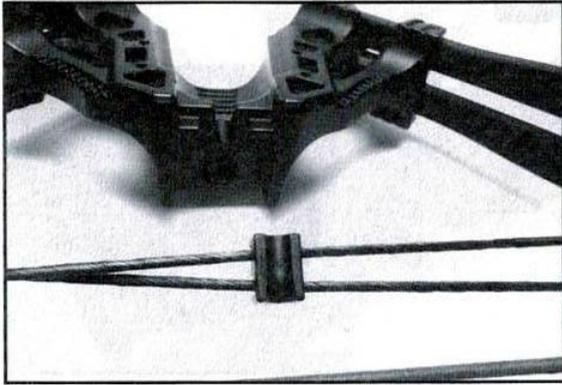
1. Вставьте бегунок на оба троса. Одна канавка в нем сделана чуть глубже - она для верхнего троса.
