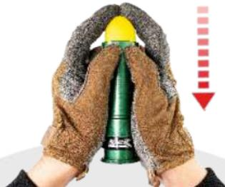
3. После взведения необходимо визуально убедиться, что устройство взведено и надежно зафиксировано. В целях обеспечения безопасности установка капсулы производится в соответствии с принципами заряжания всех дульнозарядных устройств, т.е. способами, обеспечивающими безопасность кистей рук в случае несанкционированного срабатывания механизма инициирования.
