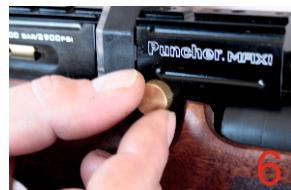
КЛАПАН РЕГУЛИРОВКИ МОЩНОСТИ МОЖНО ОТРЕГУЛИРОВАТЬ С ПРАВОЙ СТОРОНЫ (см.рис.6) - ДЕЛЕНИЯ НАХОДЯТСЯ С ЛЕВОЙ СТОРОНЫ (см.рис.7)
