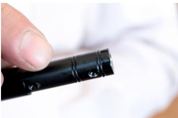
СТВОЛ ИМЕЕТ 3 УПЛОТНИТЕЛЬНЫХ КОЛЬЦА, ДВА ИЗ НИХ РАСПОЛОЖЕНЫ СНАРУЖИ И ОДИН ВНУТРИ. В СЛУЧАЕ ДЕФОРМАЦИИ, ПОЖАЛУЙСТА, ЗАМЕНИТЕ ИХ ЗАПАСНЫМИ УПЛОТНИТЕЛЬНЫМИ КОЛЬЦАМИ, КОТОРЫЕ НАХОДЯтся В КАЧЕСТВЕ ЗИПА ВАШЕЙ ВИНТОВКИ.
