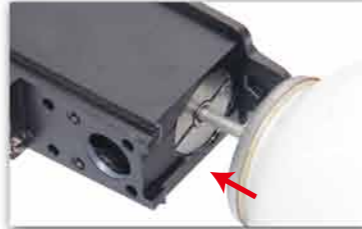
Etape 3: Gaz. Alimentez le gas dans le chargeur.
