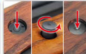
2. レシーバーの右側のホップアップ・ダイ アルを押して、ロックをゆるめてください 、そして、出てきた左側のダイヤルを調整 し、終わったら押し戻してください。
