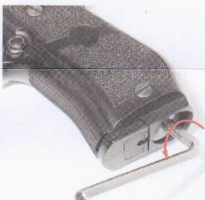
Открутите поджимную крышку баллона против часовой стрелки при помощи шестигранного ключа.
