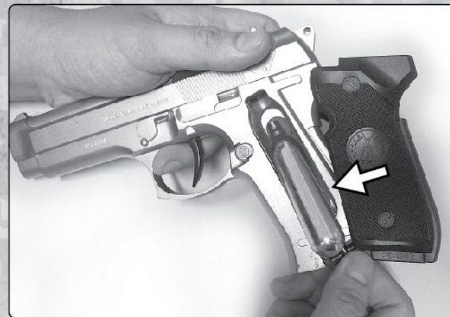
2. Вставьте новый баллон CO2 12 гр. в рамку и при помощи винта рукоятки наколите его в гнезде клапанного механизма.
