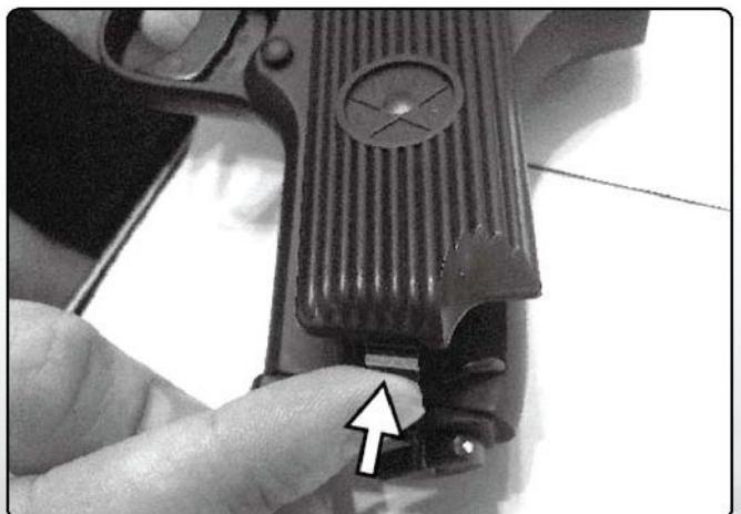
1. Поднимите левую накладку рукоятки для установки нового баллона СО2.
