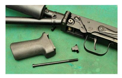
установить в шахту ствольной коробки площадку-переходник с заранее вставленной рукояткой и затянуть крепёжный винт.
