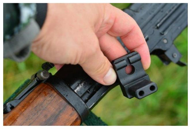
Установить на ствольную коробку и обжать стяжными винтами.
