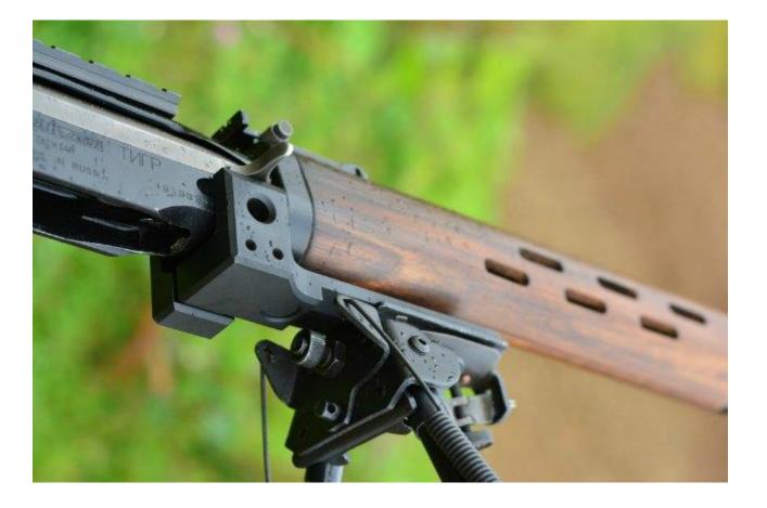
Далее. Кронштейн «Лапка», несмотря на куда более мощные габариты, почти на 100 граммов легче изделия от «Оружейного Двора». При этом «Лапка» имеет дополнительную возможность установки планки Вивер для монтажа сошек с монтажной шиной на планку указанного стандарта. Помимо этого, на «Лапку» с прикрученной планкой Вивер можно установить тактический фонарь и прочие мудрёности, тут уж каждому своё.
