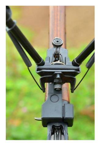
Кронштейн «Оружейного двора» крепится к оружию 4-мя небольшими 5-мм винтами с головками под шлицевую отвёртку. При монтаже шины необходимо последовательно закрутить винты, не допуская перекосов. Фиксация изделия получается «мёртвая», проблем с шиной не было в течение нескольких лет эксплуатации. Недостаток один – приличная масса стальной шины – 286 граммов.
